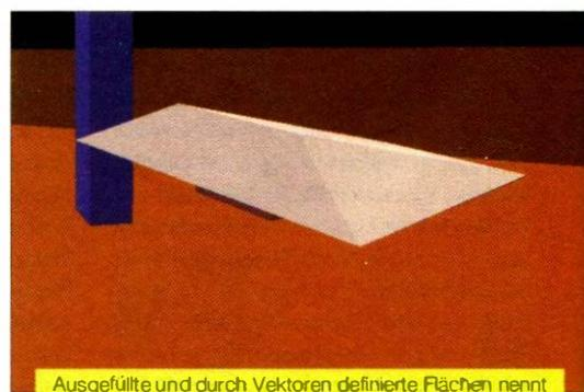
Ausgefüllte und durch Vektoren definierte Flächen nennt man Polygone. "Star Wing" verwendet die gezeigte Grafik.
